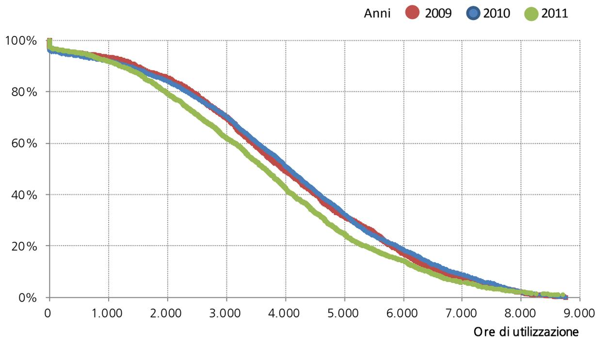
Le ore di utilizzazione equivalenti sono un indicatore molto utile per individuare, in modo semplice e diretto, l'efficienza produttiva degli impianti idroelettrici. Sono calcolate come rapporto tra la produzione lorda e la potenza efficiente lorda.
