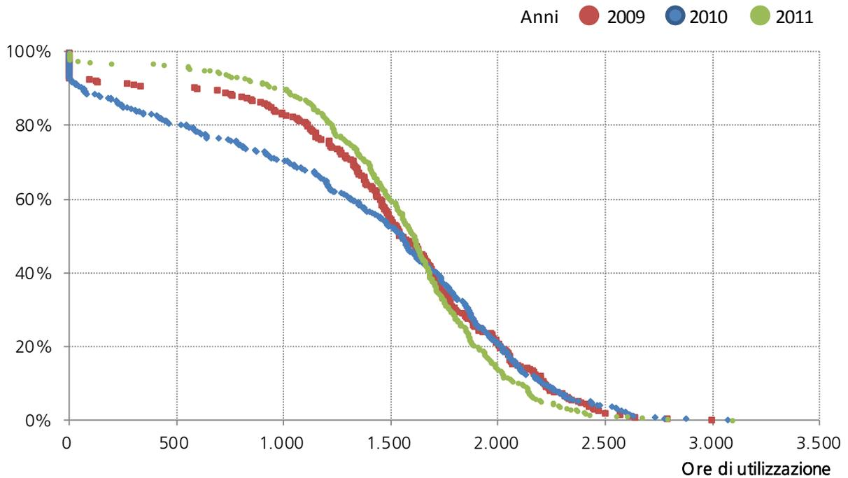
Le ore di utilizzazione equivalenti sono un indicatore molto utile per individuare, in modo semplice e diretto, l'efficienza produttiva degli impianti eolici. Sono calcolate come rapporto tra la produzione lorda e la potenza efficiente lorda.
