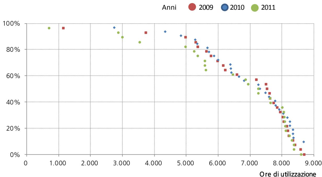
Le ore di utilizzazione equivalenti sono un indicatore molto utile per individuare, in modo semplice e diretto, l'efficienza produttiva degli impianti geotermoelettrici. Sono calcolate come rapporto tra la produzione lorda e la potenza efficiente lorda.
